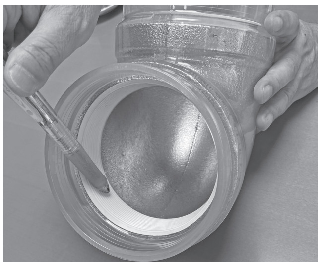
写真2 透明なねじ部分と白い漏れ止めのシールを塗布した継ぎ手
